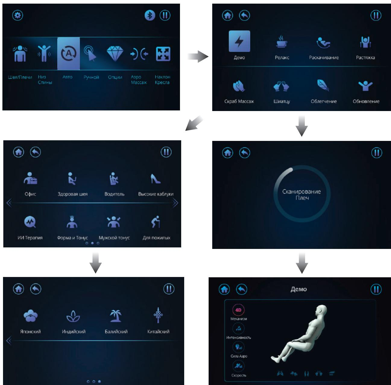
После активирования программы **ИИ Терапия** выполняется комбинированное сканирование спины вместе с определением болевых точек при помощи встроенных сенсоров HRI. Порядок сканирования приведен далее.
